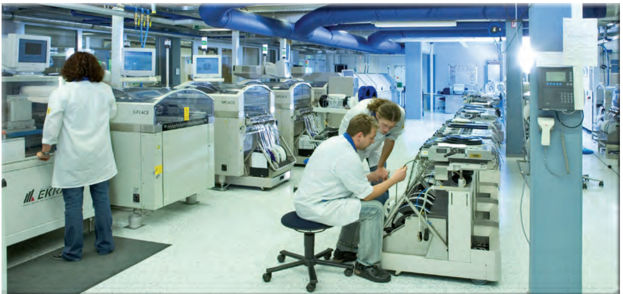
Insgesamt drei SMD-Bestückungslinien sorgen bei HEKATRON für ein enormes Datenaufkommen. Jährlich werden etwa 300 Millionen Bauelemente auf 3 Millionen Flachbaugruppen verarbeitet.
