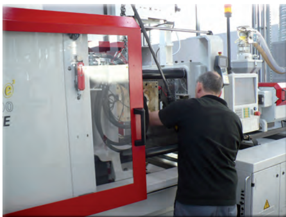
Werkzeugwechsel im einstelligen Minuten-Bereich – mit der SMED-Methodik ist das möglich.
