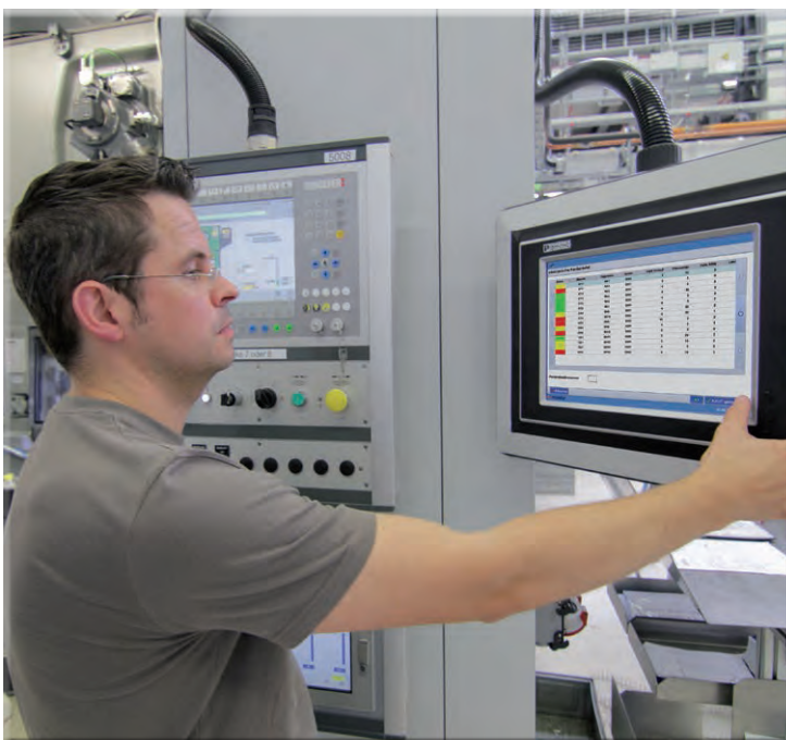
Auf der elektronischen Kanban-Tafel im MES HYDRA sieht der Werker auf einen Blick, in welchem Zustand sich die einzelnen Kreisläufe befinden. Ein zentraler Eingriff ist nicht nötig.
