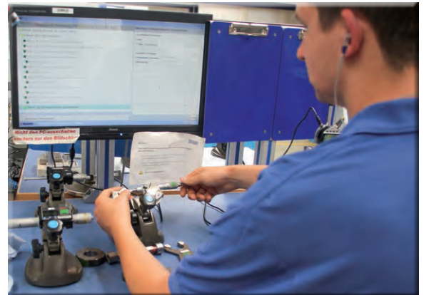
Fertigungsbegleitende Werkerselbstprüfung mit dem integrierten MES-System HYDRA.
