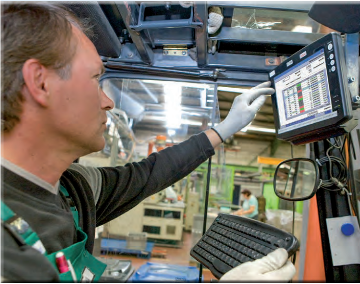
Beim dezentralen Transportmanagement im MES HYDRA kann der Staplerfahrer selbst aus den verfügbaren Transportaufträgen wählen. Dadurch entfällt eine zentrale Transportplanung.
