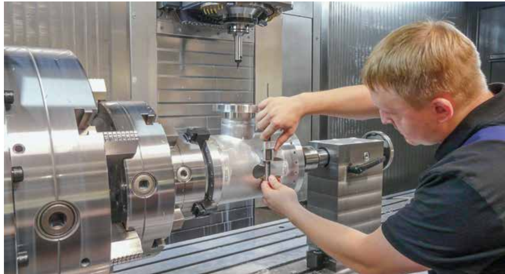
Entspricht der Durchmesser der Bohrung den Vorgaben? Ein Werker von Vacom bei der Qualitätsprüfung.
