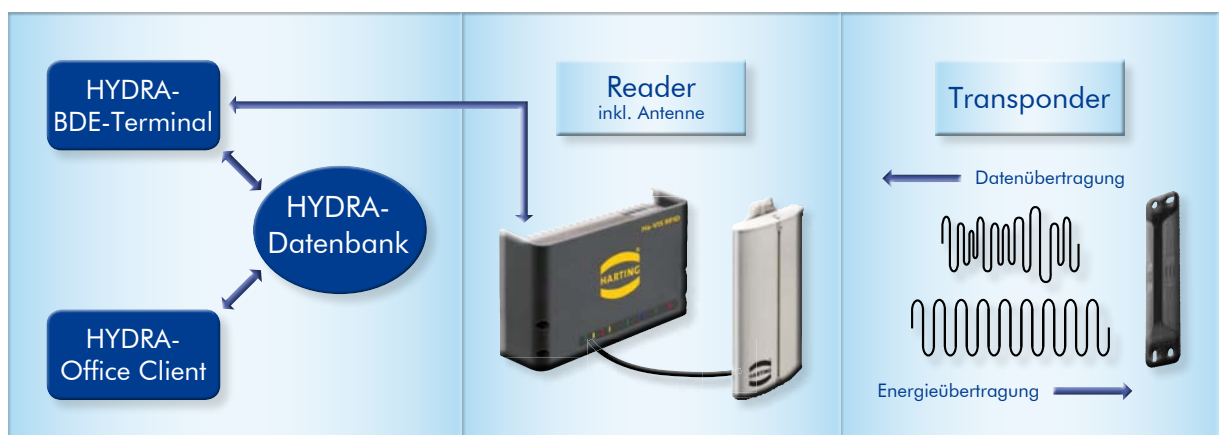
Funktionsprinzip HYDRA mit RFID
