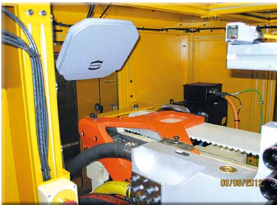
RFID-Antenne in einer Maschine zur automatischen Erkennung des gerüsteten Werkzeugs.
