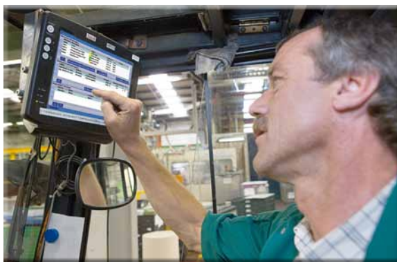
Mobile Datenverarbeitung – Mittels mobiler Terminals können die Transportaufträge, wie hier im Gabelstapler, direkt angezeigt werden.
